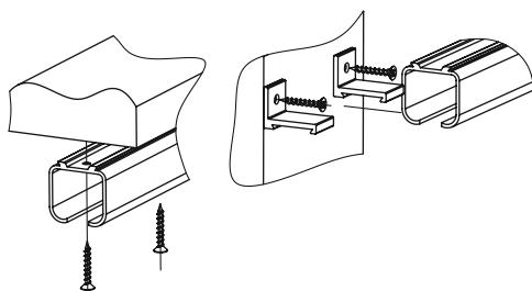
3. Устанавливаем нижнюю направляющую в дверное полотно, в заранее отфрезерованный паз, и фиксируем ее саморезами (направляющая и саморезы в комплект поставки не входят).
