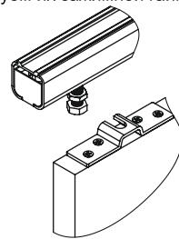
7. Выбираем необходимое положение стопора ролика и фиксируем их винтом M6.
