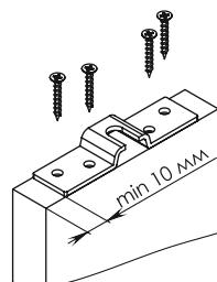
5. Закрепляем нижний направляющий ролик к полу с помощью саморезов из комплекта.
